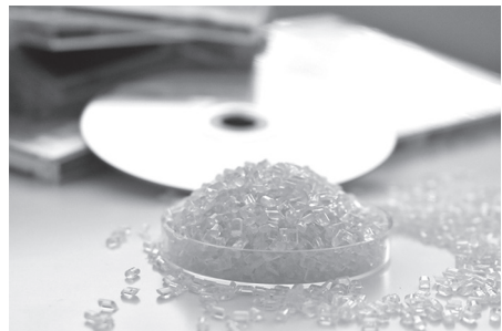
写真2 再生プラスチック資材「CDプラ」(画像はCD-PS-NA)
