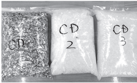
写真6 破砕されたディスクの洗浄前（左）と洗浄後（右、数字は洗浄回数）
